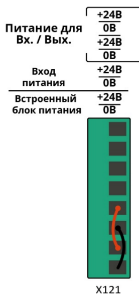
Рисунок 27 — Подключение без использования внешнего источника питания
