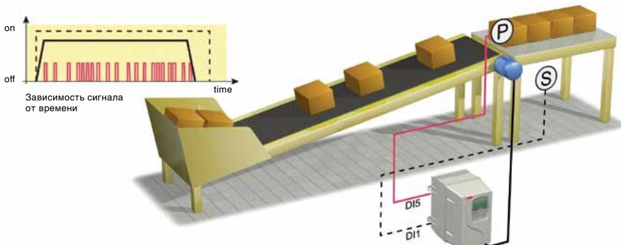
Ниже приведен пример работы функции ОСТАНОВКА ПО СЧЕТЧИКУ, используемой в процедуре разгрузки конвейера.
