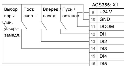
Конфигурация цифровых входов (DI) (подключение PNP) (приемник)
