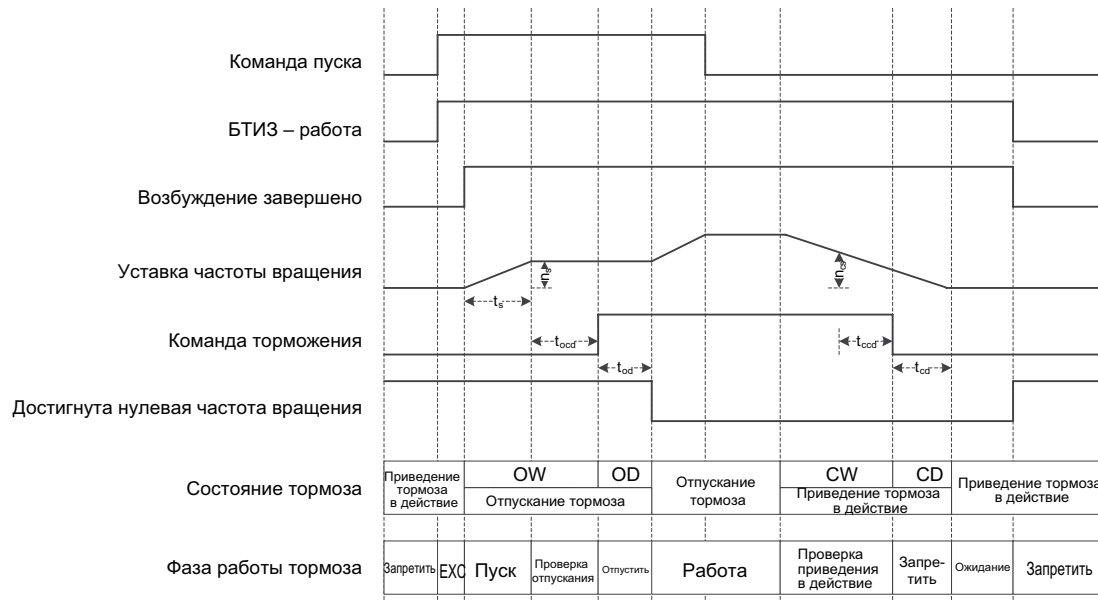
Рис. 4-22 Временная последовательность торможения в режиме частотного регулирования (V/F)
