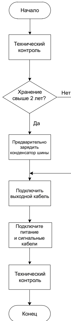
Рис. 3-1 Монтаж электротехнического оборудования – Блок-схема
